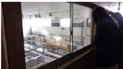
工場には夜11時から第一シフトの職員が出勤し、工場の準備をします。早朝3時半に産地から牛乳を集荷したタンクローリーの第一便が到着します。到着した牛乳を品質検査室で検査し、殺菌したものをここで充填します。充てん室がフル稼働するのが午前5時くらい、見学した午前10時頃は一日の充填作業終盤の時間でした。充填作業が終了したら、午後2時くらいまで機械の洗浄作業をされるそうです。
